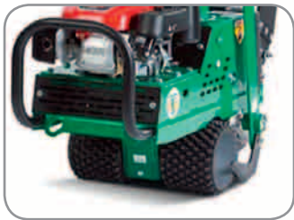
Golfwalze: Antriebswalze speziell für Golfplätze
