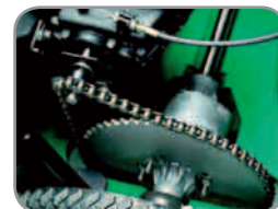
3-Gang-Getriebe, weich zu schalten.
