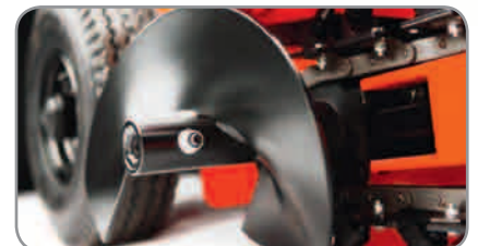
Förderschraube legt den Aushub sauber ab.
