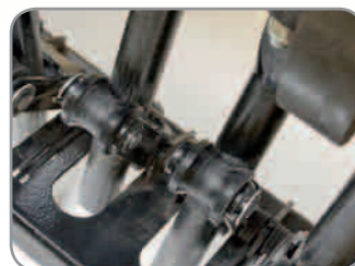
Laufbuchsenführungen für präzise Einstiche der Hohlzinken
