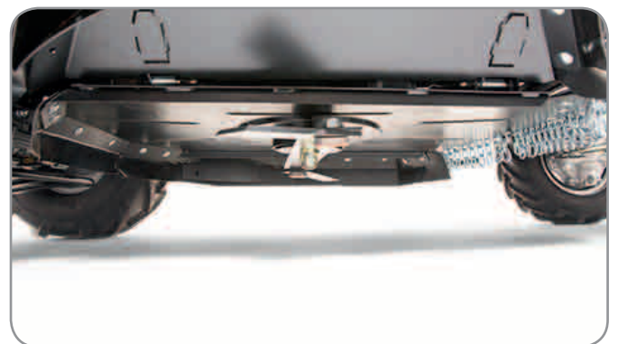
Robustes Mähwerk mit separaten Messerklingen.
