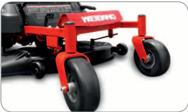
Robuste Rahmenbauweise und große Bereifung.
