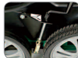
Stufenlose Höheneinstellung über Spindel.
