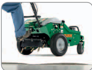
Einfaches Ausheben der Spoons per Fußraste
