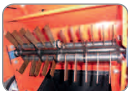
Am Fliehkraftsystem aufgehängte gehärtete 3 mm Vertikutiermesser.
