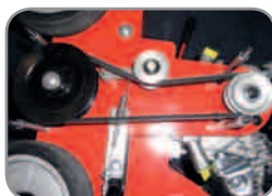
Langlebiger Messerwellenantrieb mit kugellagerter Metallspannrolle. Doppelriemen
